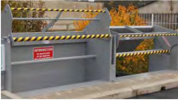
▲ Système de balancier pour vider les gravats en sécurité
