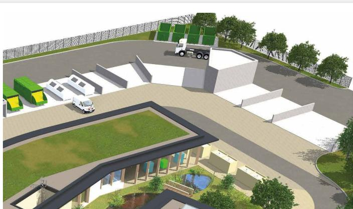
Les déchets de jardin, les gravats et le tout-venant seront déposés au sol dans des alvéoles d'une capacité de 100 m<sup>3</sup>. L'intérêt est multiple puisque l'absence de quai réduit les risques de chute, le
